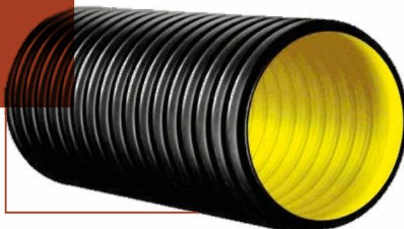
Il tubo corrugato per diametri esterni SN16 è prodotto in polipropilene alto modulo (PP) a doppia parete, di colore **nero** esternamente, per offrire un'elevata stabilità alla luce, di colore **giallo** internamente.
